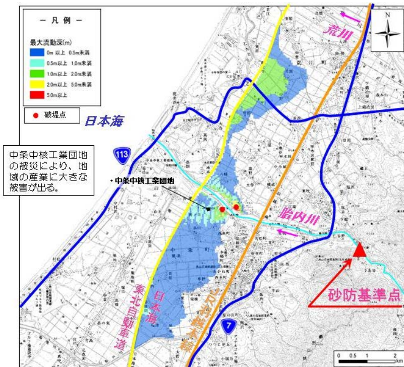
砂防基準点下流での想定被害 (無施設時：1/100年確率規模、最大流動深分布)
