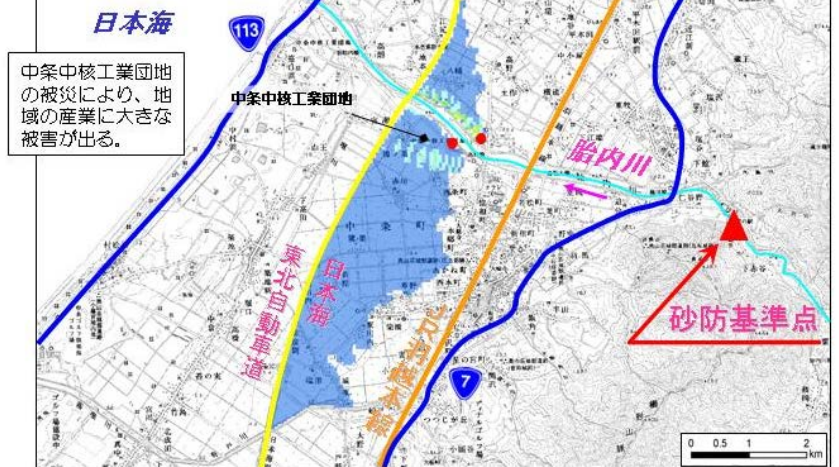
砂防基準点下流での想定被害 (現況施設時：1/100年確率規模、最大流動深分布)
